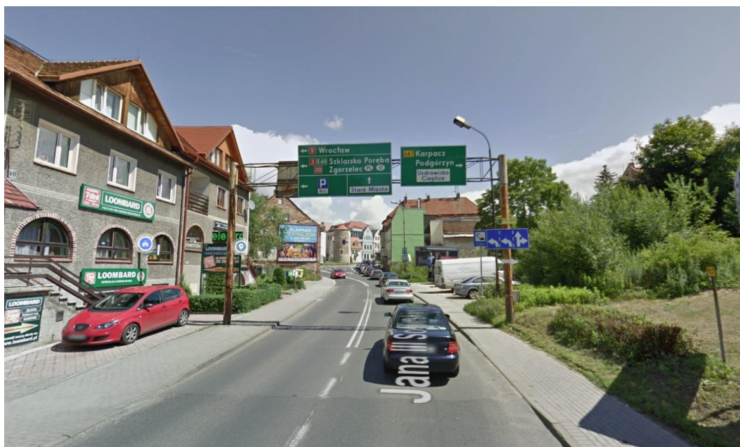
Fot. 1. Zdjęcie bramownicy z tablicami kierunkowymi E-2a – ul. Sobieskiego.
